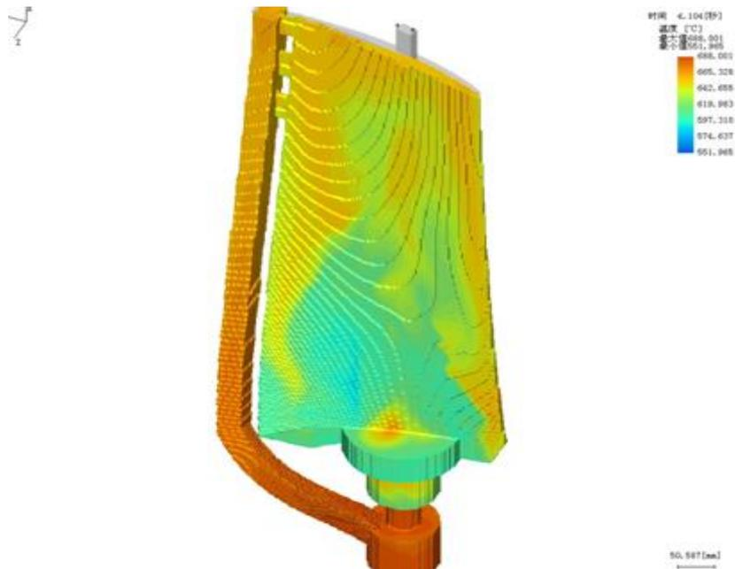
图 10 叶片铸造温度场云图
