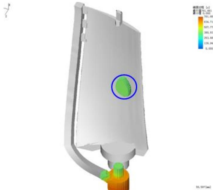
图 12 叶片铸造缩孔分析
