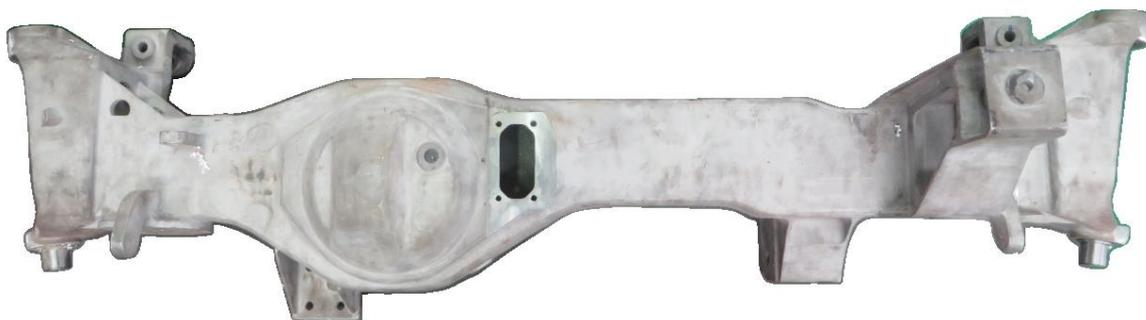
**【典型设计】**某车桥前桥壳体，通过再设计，实现了将原来由数十个钢制零件焊接而成的前桥壳整体铸造成一个零件，重量下降了 **50%**，且性能不降反升。而且整体铸造的车桥有精确的近净形尺寸精度与形位公差，减少了后续的机械加工甚至免加工，可实现使用过程中的高效率替换和维修。
