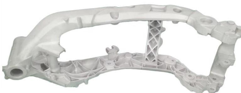
**【典型设计】**某摩托车车架，通过再设计，整体为一个零件，内部加筋、减小壁厚、减轻重量，改变传统的用焊接铆接方法把多个钢制零件集成为摩托车车架的制造方式，其结构强度、疲劳寿命、可靠性都优于传统的焊接铆接成型车架，避免了焊缝铆接存在所引起的连锁不良效应。更少的零部件，也便于进行仿真分析，仿真结果更加精确。
