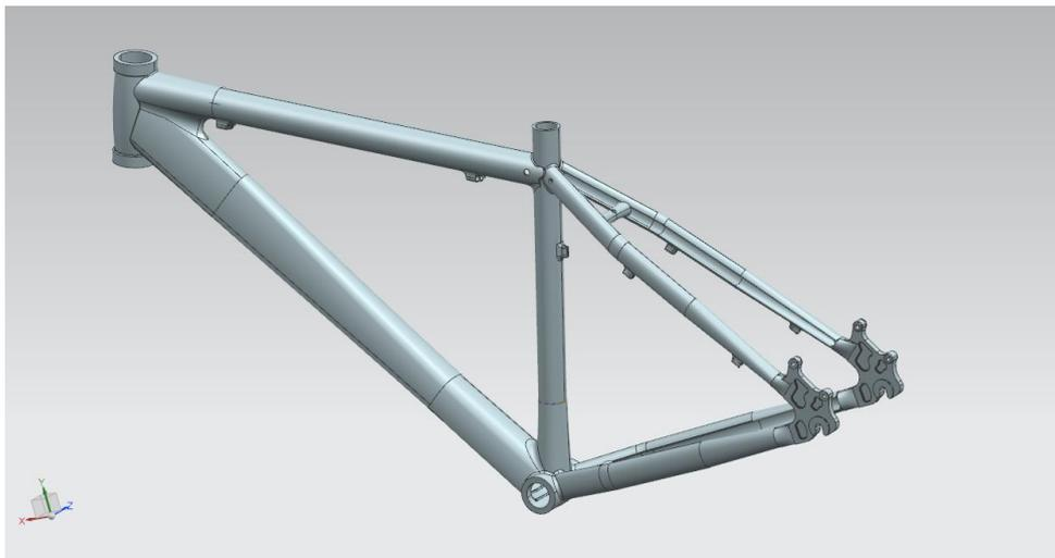
**【典型设计】**对原结构自行车车架进行优化设计，改变传统用焊接制作模式，整体铸造成型为一个铝质零件，造型自由符合人体工程学，外形更加美观。
